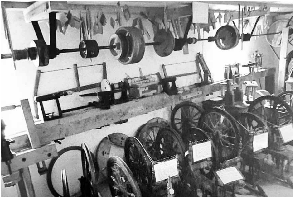
Eksempel på hjuloppheng til å overføre kraften fra vannhjulet. Foto Lund Bygdemuseum og kulturbank
