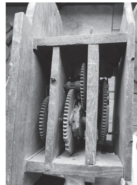
Urverket til klokken der tannhjulene er lagd av tre. Urverket er av en mye enklere konstruksjon enn de avanserte urene Pihl bygde. Foto Per Christoffer Salvesen
